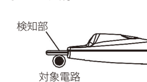
検知部の接触面が大きくなるように電線にあてる
