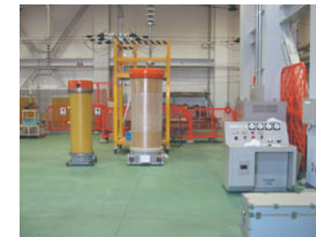
検電器試験装置
