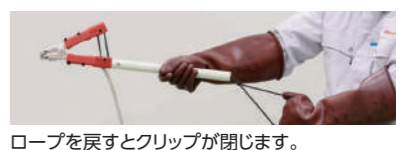
ロープを引くとクリップが開きます。
