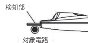
検知部の接触面が大きくなるように電線にあてる
