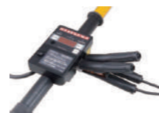
HVC-1.5N3S/M 使用前点検は付属プレートにクリップを挟んで点検を行います。
