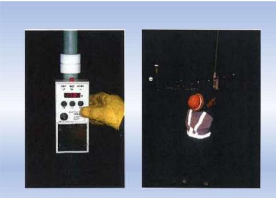
対地静電容量による電ケーブル残留電荷の影響により電停止後に検電器が鳴動する事象が発生し、作業着手遅れや作業中止が発生する為、残留電荷を素早く放電出来るものを開発。
