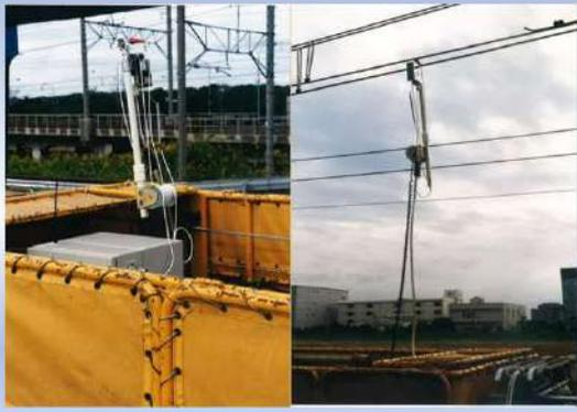
本装置は軌陸車作業台上に設置し、トロリー線の検電・仮接地を行う装置。
