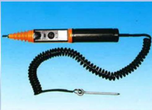
高圧配電線の停電作業時、接近平行する電車線（AC20 kV）による誘導電圧が発生し、停電回路に取り付けた接地が確実でなかった場合、誘導電圧が原因で工事などに従事する作業員が感電、墜落する危険がある為、未然に防ぎ、安全を確保する為の開発。
