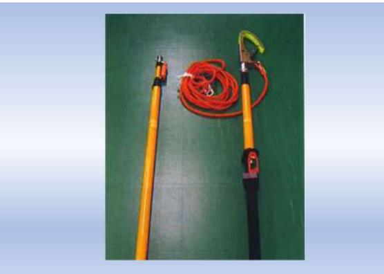
検電器で停電作業確認を行った後、カケックを取り付けるのは非効率なため、停電確認作業と取付を同時に行うことができ、使用電圧はDC1500Vでトロリー線に引っ掛けられるものを開発。
