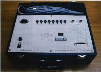
変圧器に使用する常置型負荷電流記録計と可搬型の問題点を解決し、交流負荷電流及び電圧を常時監視しあらかじめ設定されたインターバル間に発生した最大値及び1日毎の最大値、最小値、平均値を記録できる装置の開発。
