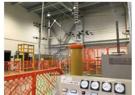
300kV発生試験設備
