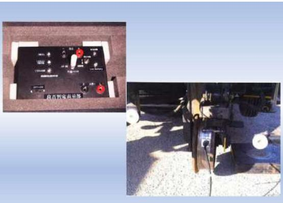
軌陸車の点検（絶縁測定）には車両下部に入り込み測定をしており、危険であり一人では行えない為、簡易に接続できる器具を開発し、安全かつ容易に測定作業を行える機器の開発。
