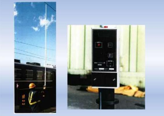
検電器各部の故障が原因で発生する誤接地事故の防止及び停電作業方法の改善を図る為、検電器に電圧表示機能を持たせ、接地線の断線が確認でき、チェッカーを内蔵したものを製作。
