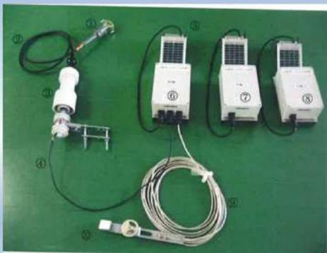
き電停止になっているか否かを目で見えて判断できる装置の開発。
