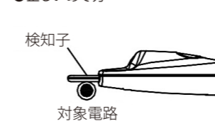
検知部の接触面が大きくなるように電線にあてる
